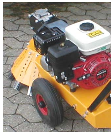
Kraftig Honda motor - kraftige stålborster - store fastgummihjul
